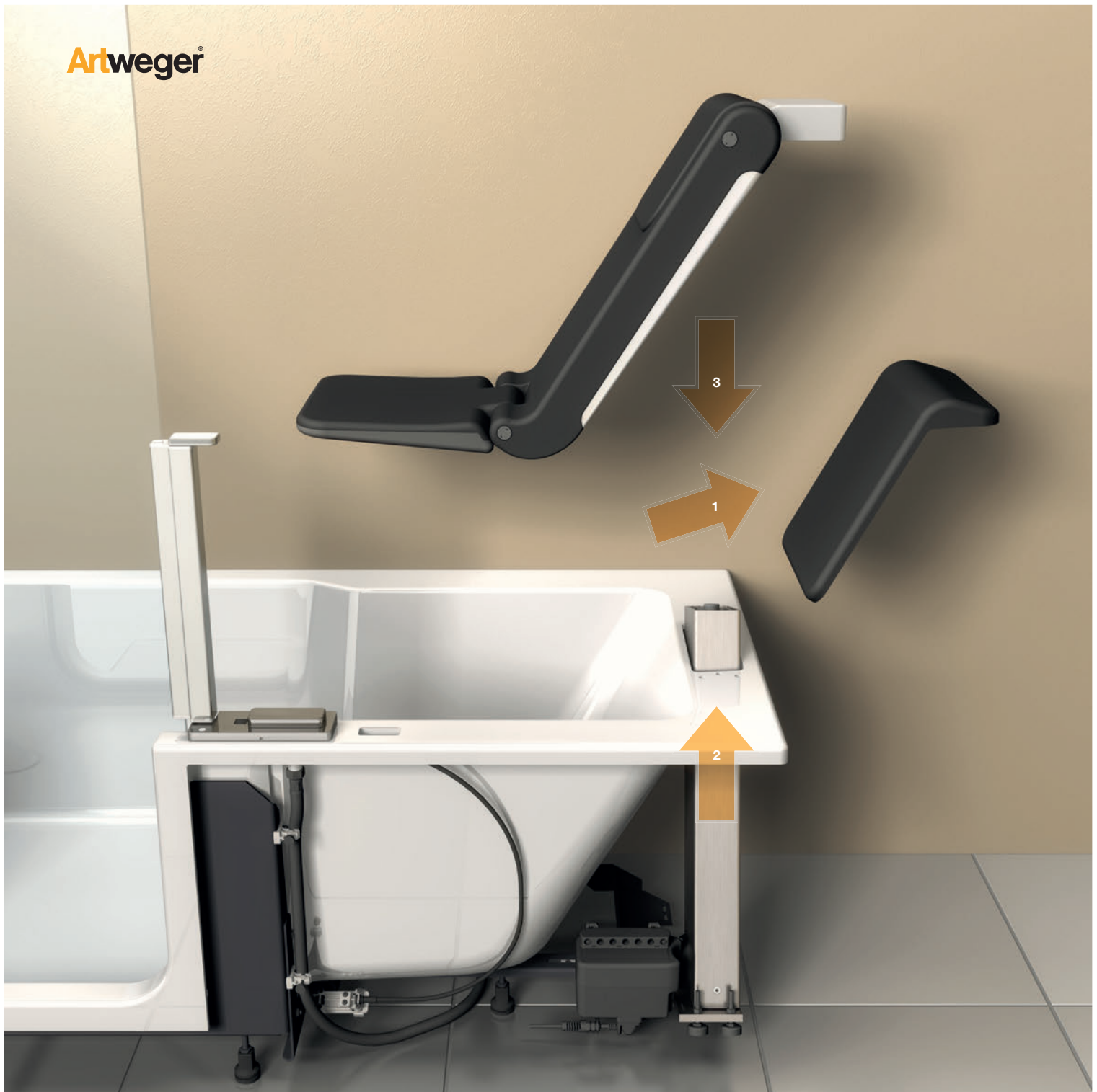
Zo gemakkelijk wordt vroeg of laat de ARTLIFT badlift ingebouwd: 1) De rugleuning wordt verwijderd 2) de zuil wordt geplaatst en 3) de badlift wordt gemonteerd
